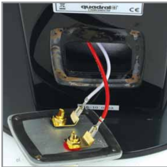
Il retro della vaschetta dei contatti di potenza.
