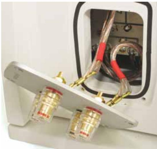
I morsetti di ingresso, sdoppiati e di qualità elevata, sono montati su una piastra metallica. Nella foto si intravede anche la scheda sulla quale alloggiavano i componenti del crossover.
