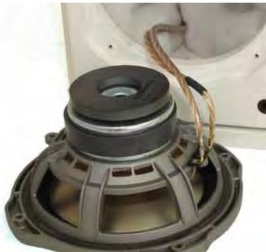
Il woofer da 16 cm ha la membrana in un composto di alluminio, titanio e magnesio, il cestello pressofuso e il magnete schermato. Il cablaggio è effettuato con cavo Real Cable misto rame-argento.
